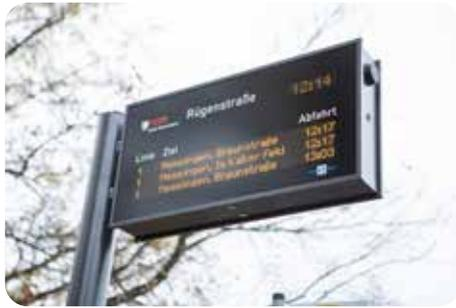
Vier E-Busse, Midi- und Minibusse sind im markanten Stadtbus-Design unterwegs. Links: An 25 Steigen wurden DFIs (Dynamische Fahrgastinformation) installiert. Sie zeigen in Echtzeit, wann der nächste Bus zur Haltestelle kommt.
