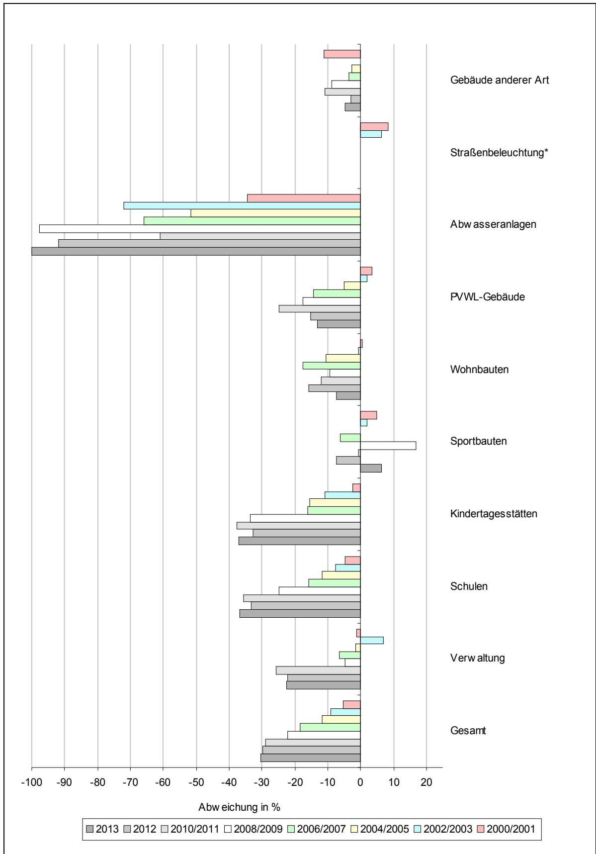
Abb. 4-29: Heizenergiebezugsänderungen kommunaler Einrichtungen der Stadt Memmingen im Vergleich zu den Vorjahren (Mittelwert 1997 bis 1999) nach Gebäudegruppen (klimabereinigt, mit Ausnahme der Klärwerke)
