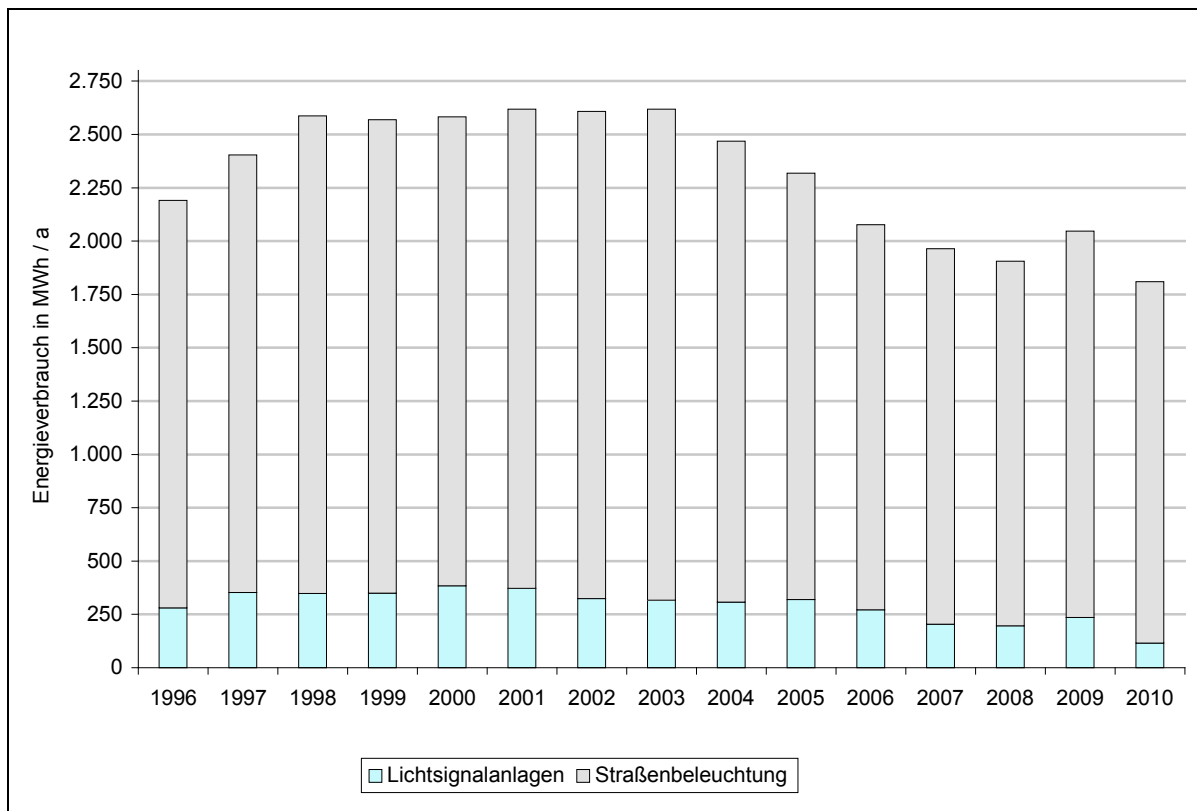
Abb. 4-16: Entwicklung des jährlichen Strombezugs (Strom - LKP) der Lichtsignalanlagen bzw. der Straßenbeleuchtung der Stadt Memmingen
